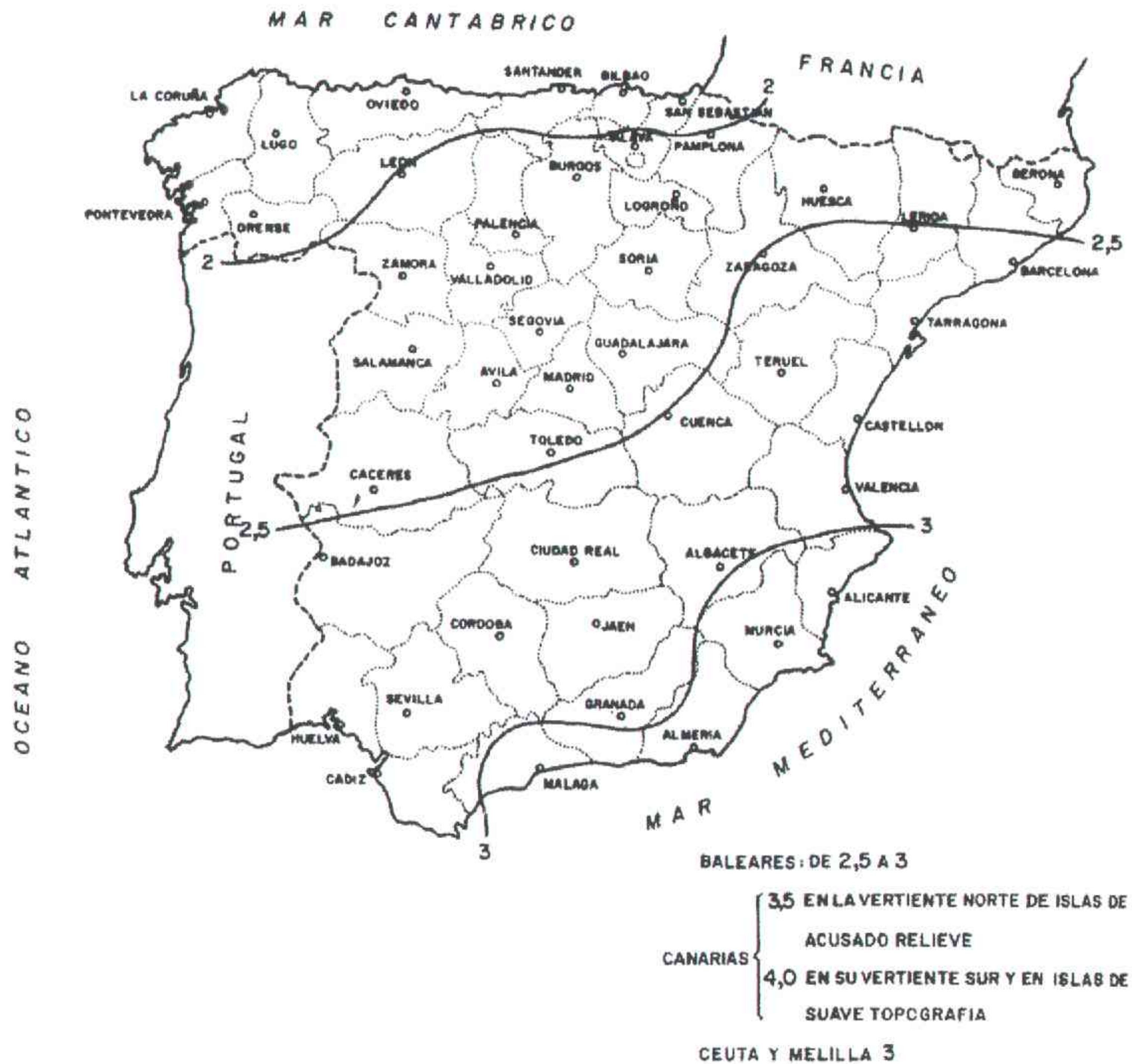
Ilustración 14. Coeficiente corrector del umbral de escorrentía P_0 .
