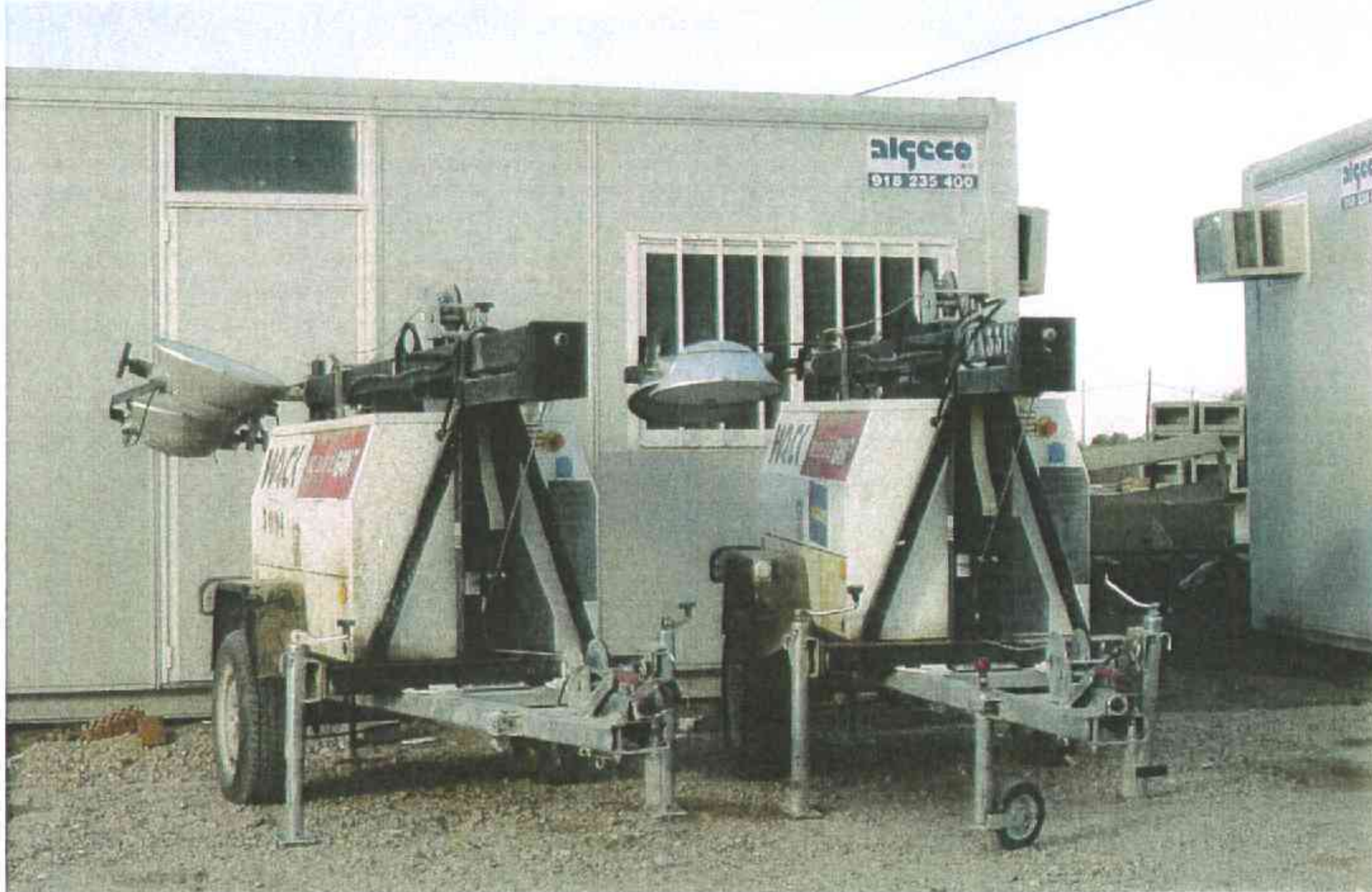
Sistema de iluminación utilizado habitualmente en construcción.
